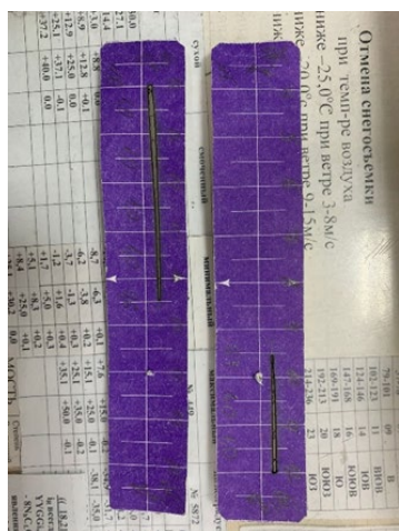
Рис. 4 - Ленты гелиографа. Прожог имеет вид линии, по длине которой судят о продолжительности сияния
