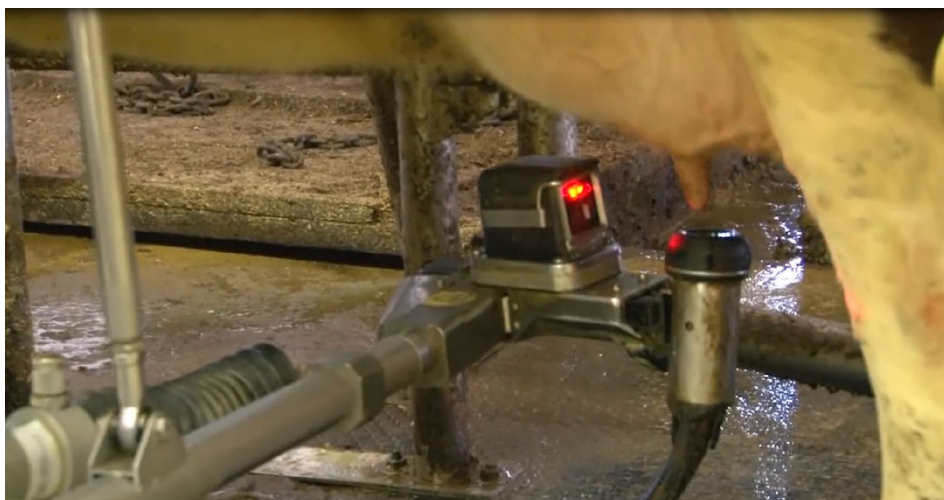
Рис. 4. Робот-дойяр в работе
