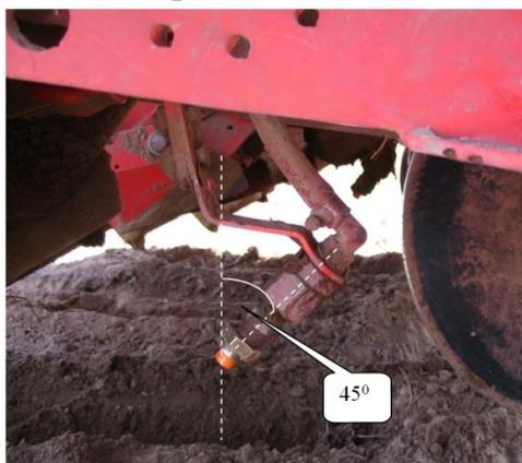
Рисунок 2 - Оптимальные углы установки распылителей
